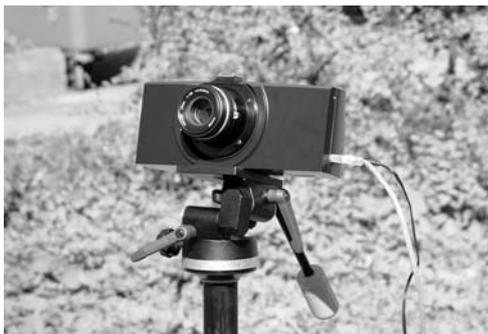
**Abb. 1:** Zeilenscanner-Kamera Pentacon Scan 5000
