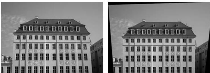
**Abb. 5:** Architekturphotogrammetrie – digitale Entzerrung einer Fassade
