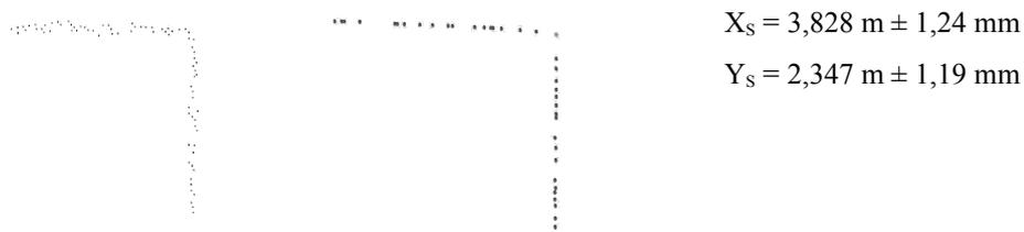
**Abb. 2:** Originalpunktewolke (links) und berechneter Schnittpunkt im glatten Profil (rechts) mit den Koordinaten  $X_s \pm \sigma_x$  und  $Y_s \pm \sigma_y$
