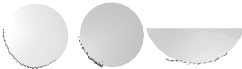
Abb. 3: Draufsicht auf Laserscannerpunkte von Horizontalprofilen in Brusthöhe mit ausgeglichenen Durchmessern
