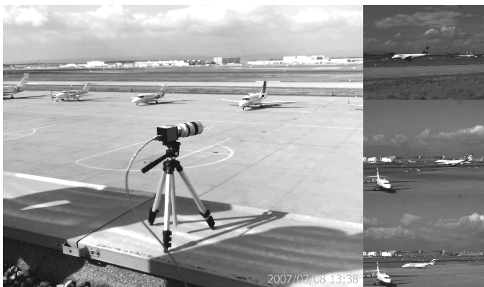
Abb. 3: links: Kamera TIS auf Standpunkt 512 (Frankfurter Flughafen), rechts: Bilder aus 3 verschiedenen Messsequenzen
