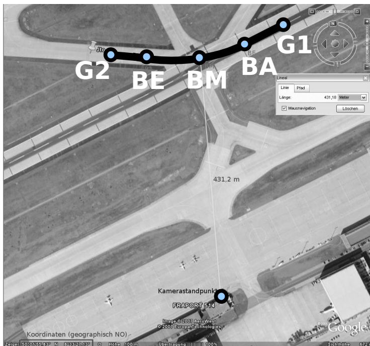
Abb. 1: Kurvenverlauf Landebahn Süd auf JTO (Abrollweg) mit den definierten Kurvenabschnitten (G1, BA, BM, BE, G2)
