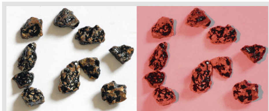
Bild 4: Aufnahmen von bitumenumhüllten Schottersteinen unter Tageslicht (links) und zusätzlicher Laserdiodenbeleuchtung (rechts)
