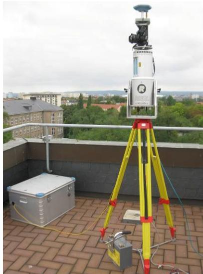
Abb. 1: Geodätische GNSS-Antenne auf einem Riegl LMS-Z420i Laserscanner
