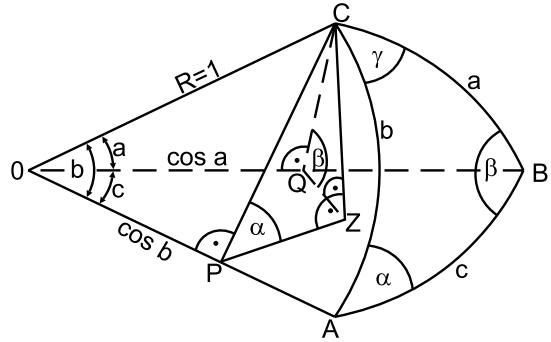
Vom Punkt C wird das Lot auf die Ebene OAB bis Z gefällt. Ebenfalls von C werden die Lote auf die Kanten OA bis P und OB bis Q gefällt. Schließlich wird Z mit P und Q verbunden.
