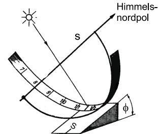
c) **Vertikaluhren** mit zum Pol gerichtetem Schattenstab.
