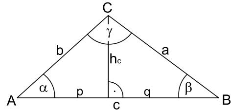
Nach dem Gleichsetzen erhält man den ebenen Sinussatz
