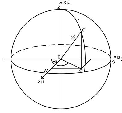
Wird der Kugelradius gleich 1 gesetzt, kann der Vektor  $\underline{x}_1$  durch die Komponenten  $x_{11}, x_{12}$  und  $x_{13}$  ausgedrückt werden:
