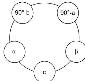
Jetzt gilt die Regel: Der Kosinus eines Stücks im Neperschen Ring ist gleich dem Produkt der Kotangens der beiden anliegenden Stücke oder gleich dem Produkt der Sinus der beiden nichtanliegenden Stücke (Formelsammlung C.11.).
