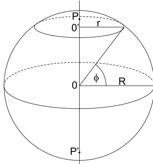
Die im Mittelpunkt auf einer Kreisebene K mit dem Radius r senkrecht stehende Gerade trifft die Kugeloberfläche in den Polen P (Nahpol) und P' (Fernpol).
