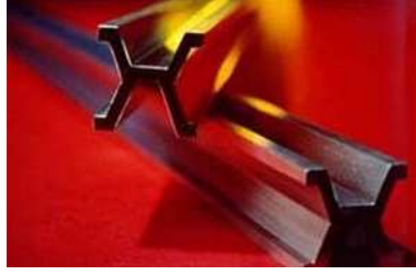
Abbildung 3.22: Alter Internationaler Meter-Prototyp: ein Standardbarren aus Platin-Iridium. Dies wurde genutzt als Längennormale bis 1960. Heutzutage ist das Meter über die Laufzeit von Licht im Vakuum definiert.
