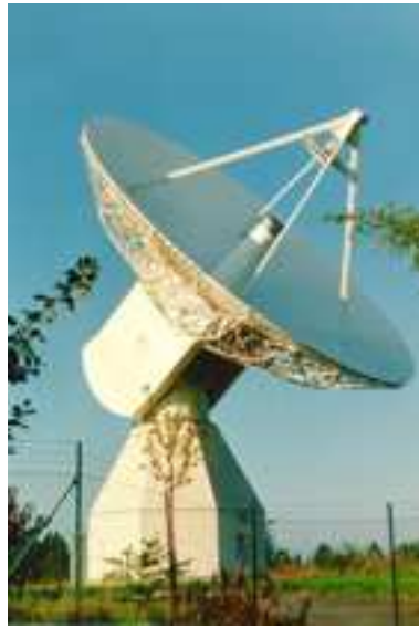
Abbildung 5.12: VLBI-Radioantenne der geodätischen Fundamentalstation Wettzell.
