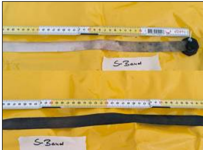
Abbildung 26: Schwefel-Detektor: (oben: 1 Woche, unten: 4 Wochen nach Beginn, Braunfärbung zeigt ein sulfatreduzierendes Milieu an)
