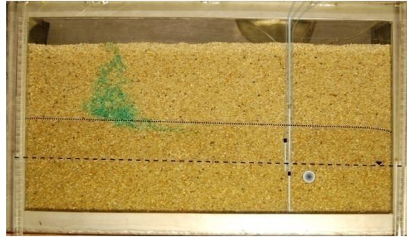
Abb. 2-13 Exp1, Tracerverlauf 10min nach Injektion
