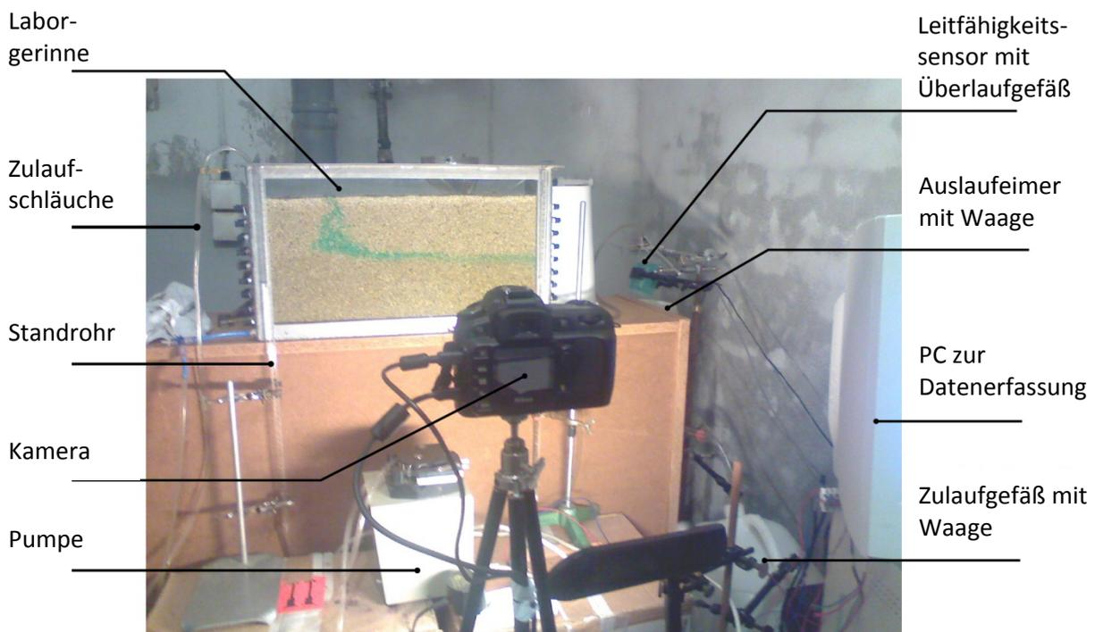
**Abb. 2-3** Experimentaufbau im Laborkeller des IGW
