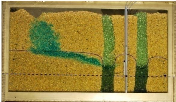
Abb. 2-29 Exp2A, Tracerverlauf 20min nach Injektion
