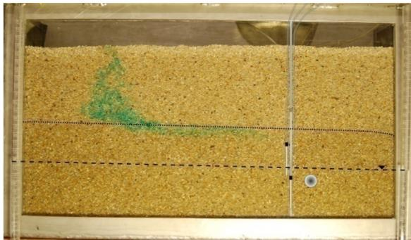
Abb. 2-14 Exp1, Tracerverlauf 30min nach Injektion
