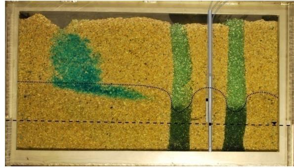
Abb. 2-28 Exp2A, Tracerverlauf 12min nach Injektion
