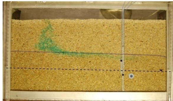
Abb. 2-15 Exp1, Tracerverlauf 40min nach Injektion
