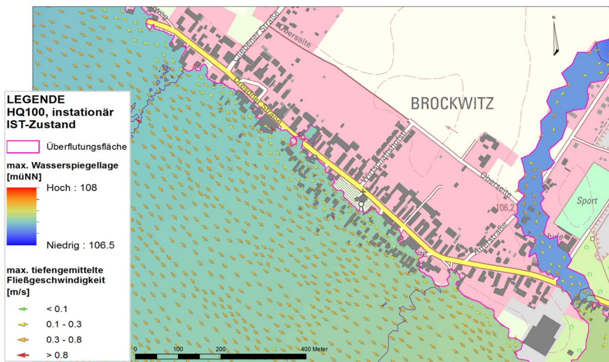
Abb. 7: Maximale Wasserspiegellagen, Überflutungsflächen und tiefengemittelte Fließgeschwindigkeiten für instationäre Berechnung mit HQ100, Ist-Zustand
