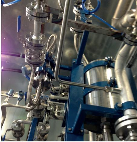
Abb. 10: Zweistufige Membrananlage für die Abtrennung von  $CO_2$  aus Rauchgas (Bild: T. Brinkmann, Hereon).
