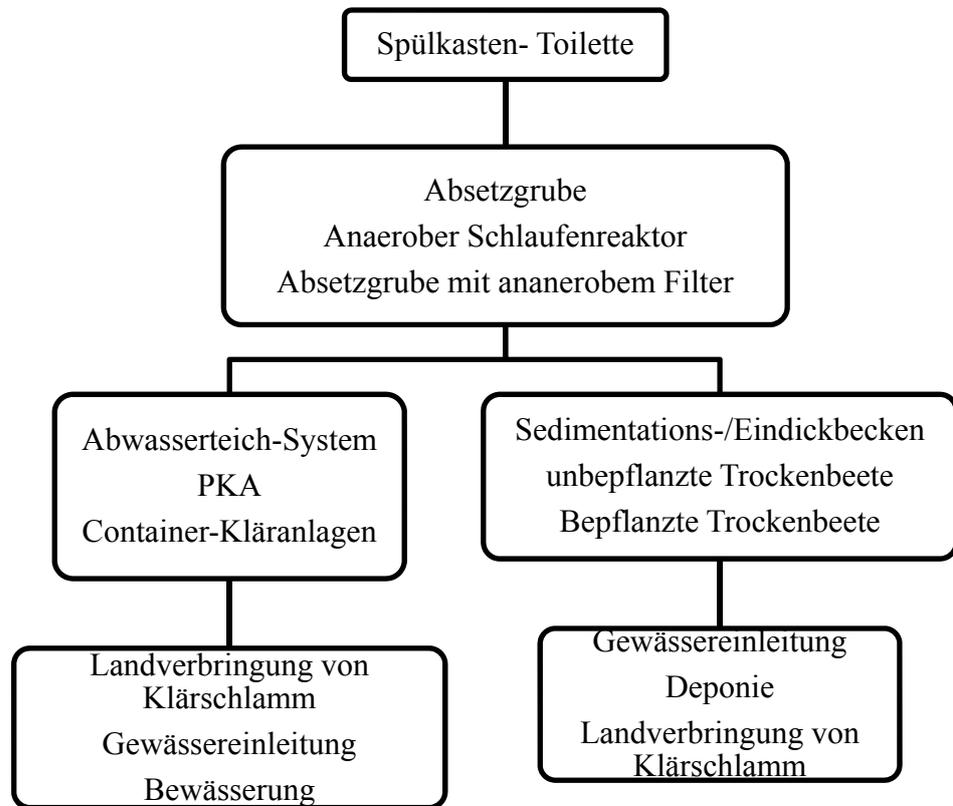
**Abbildung 18: Übersicht möglicher Komponenten für Spülkasten- Toilette**
