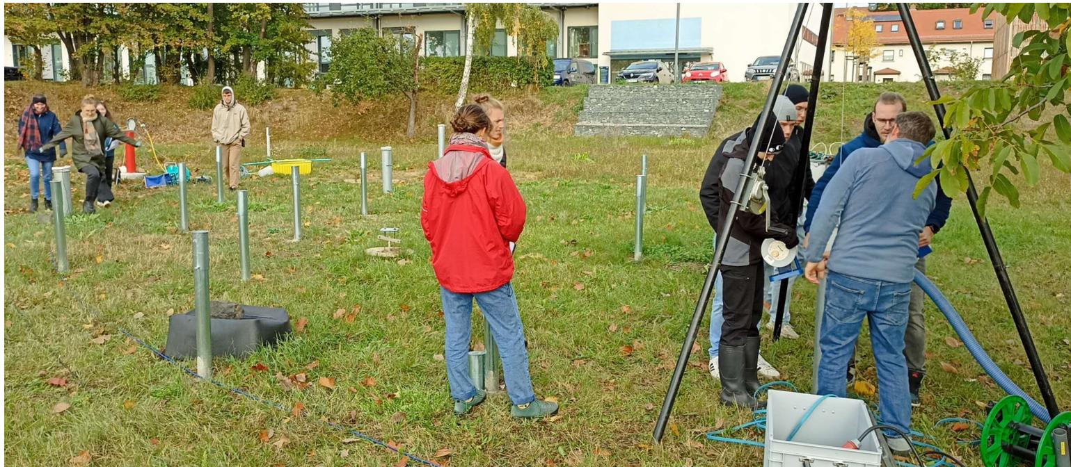
Durchführung eines Pumpversuchs auf dem Lehr- und Forschungsfeld des IGW (Quelle: Chen)
