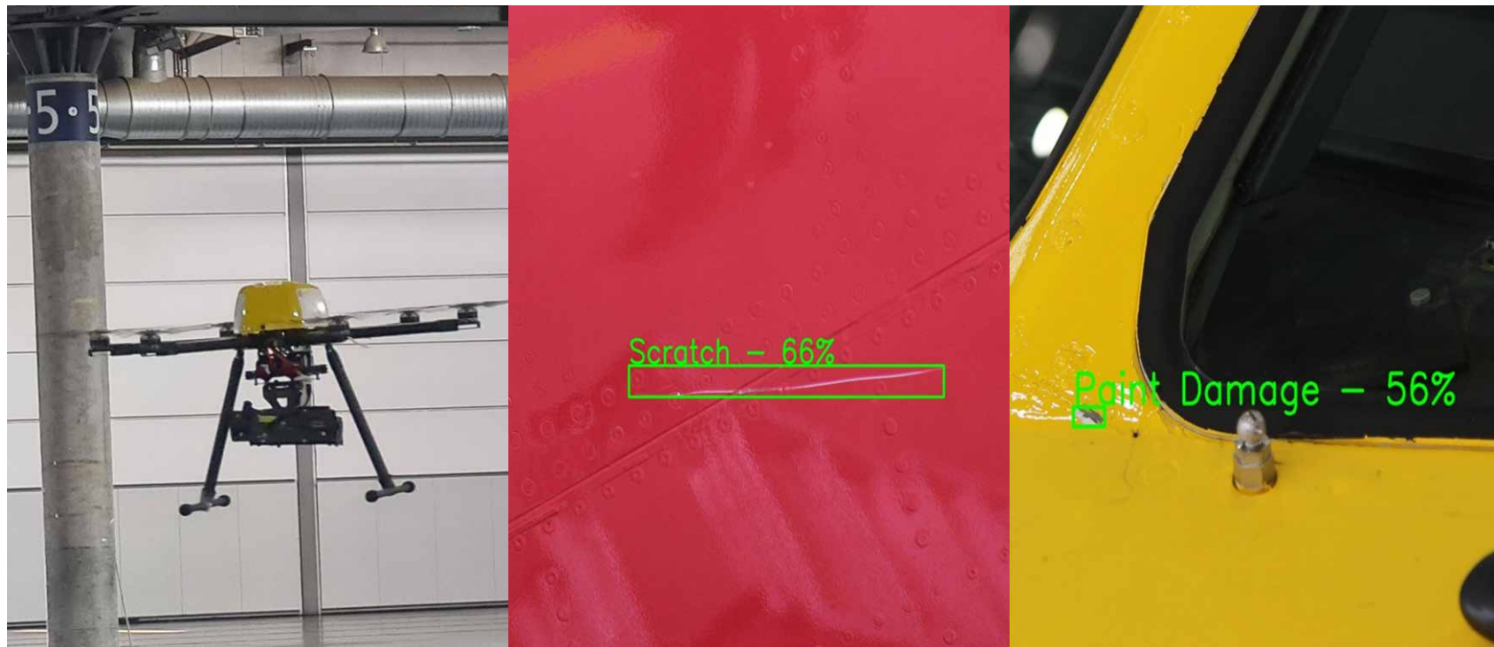
KI-Basierte Erkennung von Schäden an Flugzeugen im Hangar von DHL mittels dem Einsatz von Drohnen
