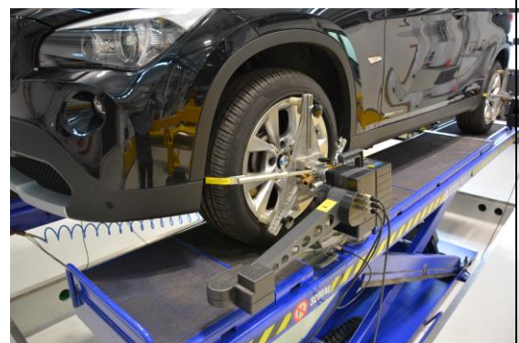
Stabile Schieberunterstütze mit schwenkbar/ schiebbarer oberen Platte zum verspannungsfreien Vermessen/ Einstellen der Hinterräder.
