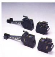
Die Messwertnehmer mit autarker CCD-Messensorik übertragen die Daten zum PC.
