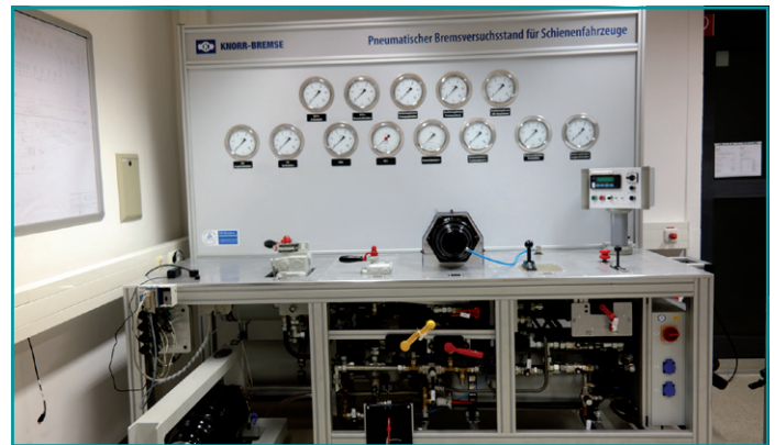
Abb. 3 Pneumatischer Bremsenversuchsstand für Schienenfahrzeuge
