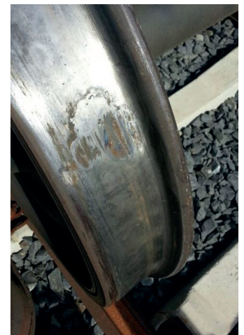
Bild 3: Flachstelle auf der Radoberfläche
