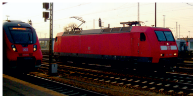
Bild 1: Bahnalltag in Deutschland; links: Nahverkehrstriebwagen Talent 2, mitte: moderne Drehstrom-Elok BR 145 als Arbeitstier im Güterzugdienst
