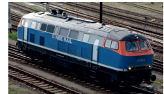
Bild 8: Eine remotorisierte BR 218 als Beispiel für Fahrzeuge mit Zentralantrieb
