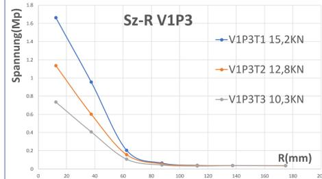
Die Trends der  $\sigma_z$  über R sind in den 2 Versuchen gleich. Die Spannungen sind im zentralen Bereich am größten, dann sinken sie sehr schnell bis zum 4. Kreisring. In den äußeren Kreisringen bleiben sie stabil.
