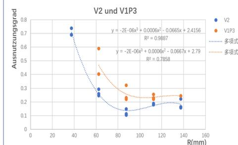
Für Spannungen von gleicher Größe, aber verschiedener Wirkungsweise: Die Trendlinie von V1P3 liegt höher als V2: Die innere Struktur wird nicht stabiler, sondern lockerer, wenn der Sand mehrmals belastet wird. Diese Ergebnisse widersprechen der Erfahrung.
