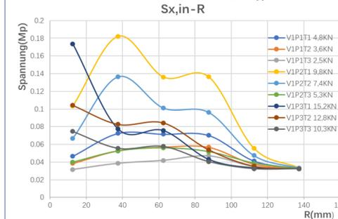
Die Trends der  $\sigma_x$  über R sind unter verschiedenen Belastungen unterschiedlich: 0-10KN:  $\sigma_x$  sind im 1. Kreisring klein, im 2. - 4. Kreisring sind sie größer, dann sinken sie bis zur Grenze. Diese Trends entsprechen nicht den Trends der  $\sigma_z$ .
