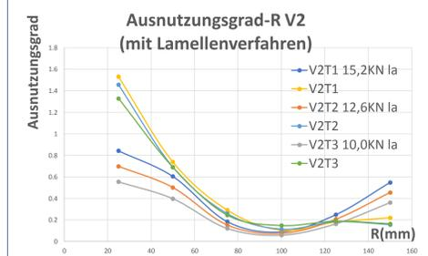
Die mit Lamellenverfahren berechneten  $\sigma_{z,la}$  stimmen gut mit  $\sigma_{z,ist}$  überein. Für den Ausnutzungsgrad  $\alpha$  gilt:  $\alpha_{la}$  sind im inneren Bereich kleiner als  $\alpha$ .
