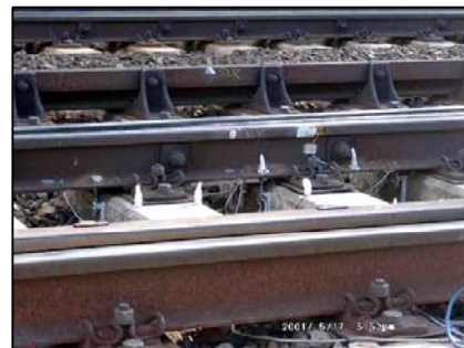
Übersicht der Messpunkte am Herzstück
