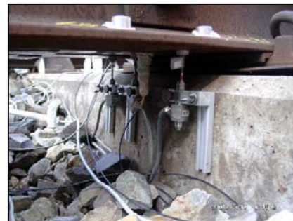
3 Messpunkte für Wegaufnahme zur Aufnahme der Differenzwege
