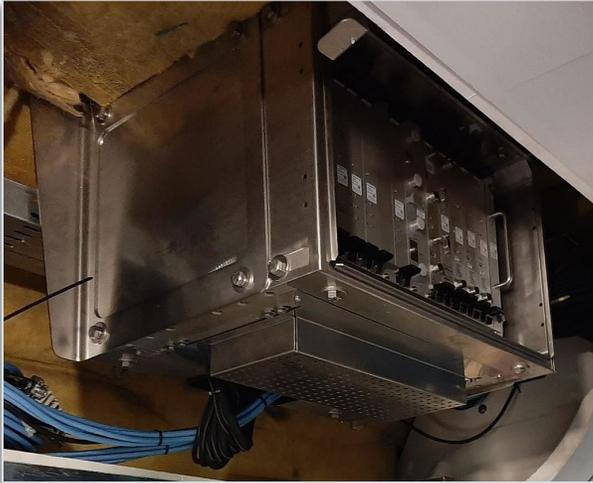
Im Deckenbereich montierter ETCS-Fahrzeugrechner (EVC)
