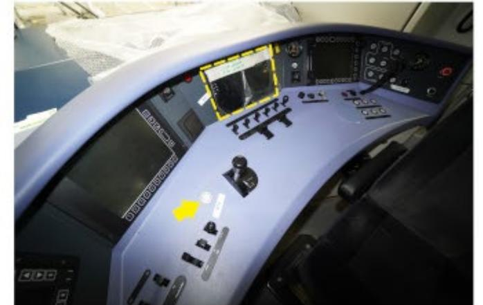
neue Displays und ATO-Taster in einer S-Bahn der Baureihe 423
