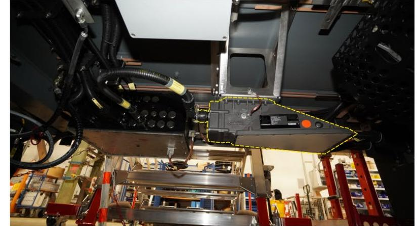
Dopplerradar unter einer S-Bahn der Baureihe 430
