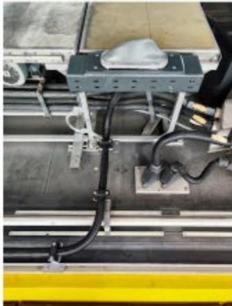
Antenne für 4G/5G auf dem Dach eines FLIRT 3
