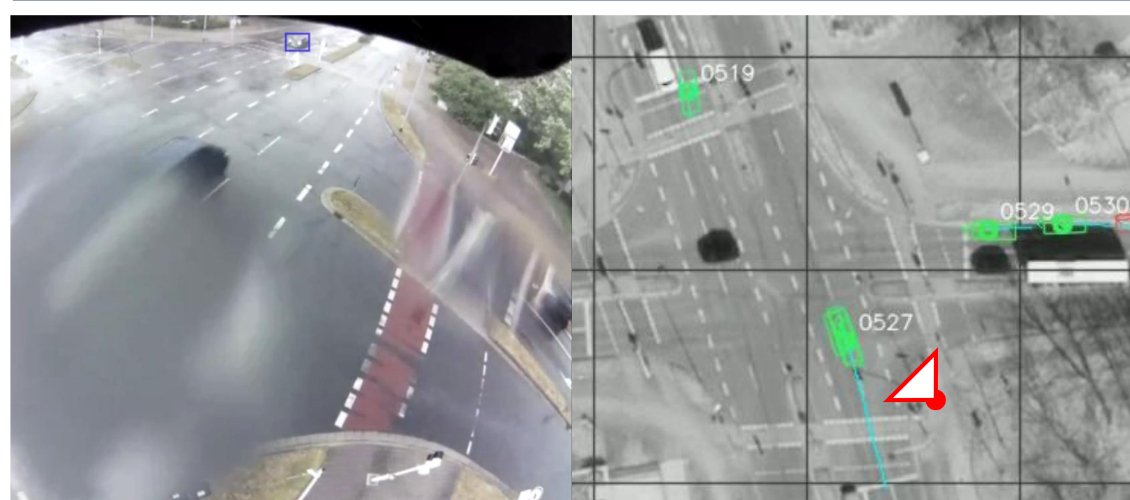
Abb. 3: Die Trajektorien-Fusion ermöglicht es auch verdeckte Fahrzeuge zu erkennen. Einzelkamera (links), Multikamera-Trajektorienfusion (rechts).
