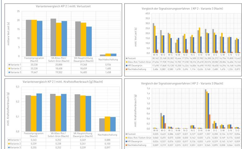
Abb. 5: Beispiele für den Vergleich der Knotenpunkt- und Signalisierungsvarianten für den Knotenpunkt 2 (Gesamtknotenbetrachtung – links, fahrfstreifenfeine Betrachtung – rechts)
