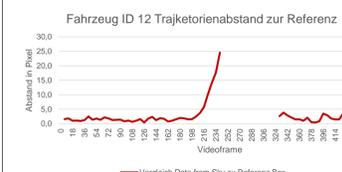
Von der 854 Referenzpunkten konnte Data from Sky 770 und STRUDL nur 215 Punkte erfassen. Die Ergebnisse von Dfs lagen im Schnitt 5 Pixel (MAE) neben der Referenzkoordinate. Bei STRUDL beträgt der mittlere absolute Fehler 13 Pixel.
