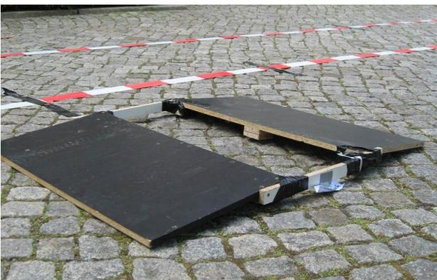
Aus Spanplatten werden zwei flache Rampen konstruiert. Diese werden mit Kanthölzern so verbunden, dass ein „Loch“ von ca. 40 cm entsteht.
