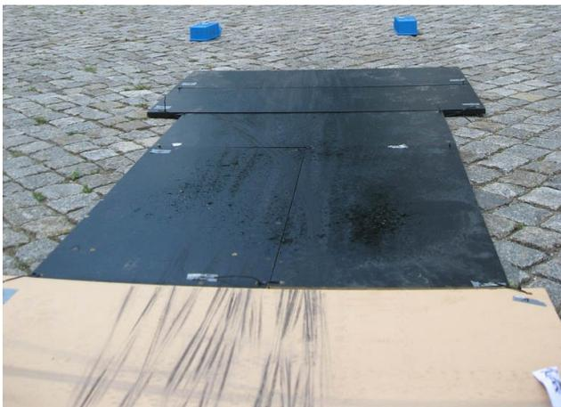
Einige Spanplatten werden durchbohrt und mit Kabelbindern verbunden. Mit einer Sprühflasche wird Seifenwasser aufgebracht.
