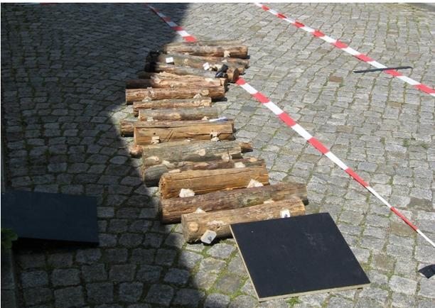
20 ca. 50 cm lange Rundhölzer werden durchbohrt und mit Seilen nach Art einer Strickleiter verbunden. Als Abstandshalter werden zu 3x3 cm zurechgesägte und ebenfalls durchbohrte Spanplattenstücke eingesetzt.
