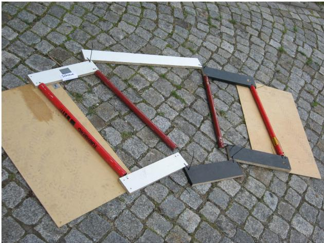
Metallrohre werden durch Kabelbinder mit Brettern verbunden. Durch unterschiedliche Abstandshalter können beliebige Konfigurationen realisiert werden.
