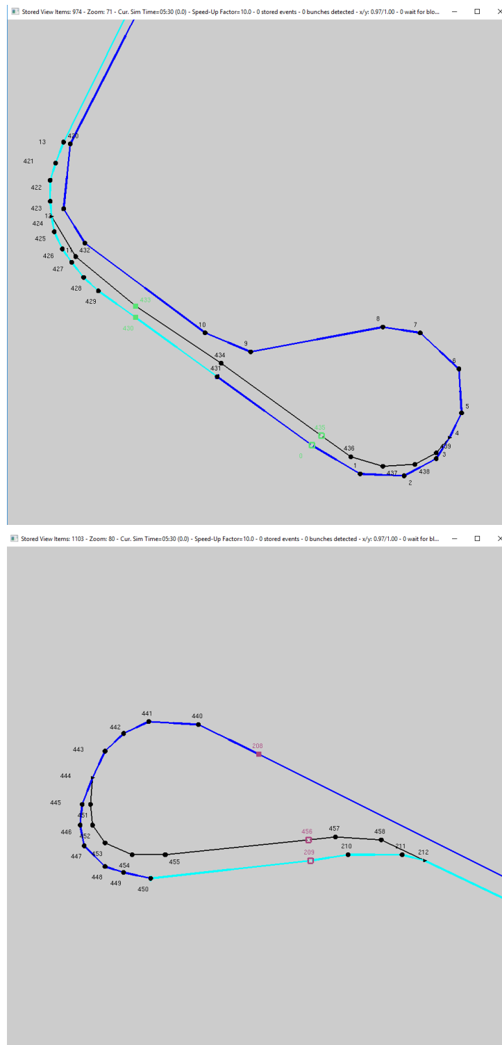
Abbildung 26: Simulationsfenster mit den beiden spezifizierten Linienverläufen der Linie 13 an den Wendeschleifen in Prohlis (oben) und Kaditz (unten)
