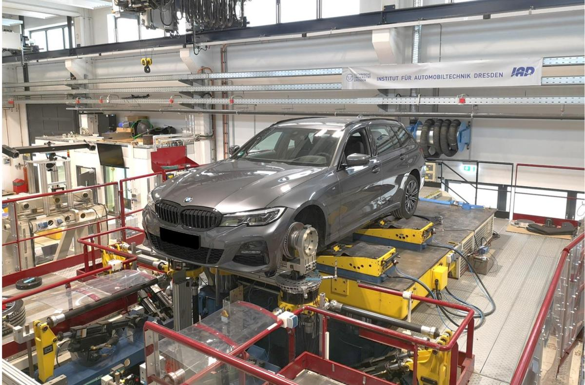
Abbildung 1: Gesamtansicht des Suspension Motion Simulators mit Versuchsfahrzeug
