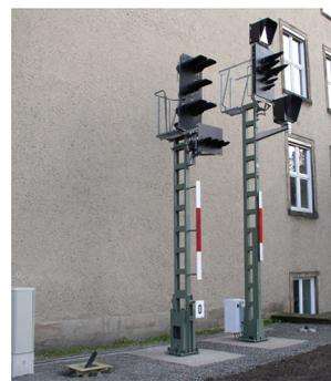
Seit Ende des Monats sind nun im Außenbereich des Gerhart-Pothhoff-Baus zwei Hauptsignale des H1- und Ks-Systems nicht mehr zu übersehen. Diese wurden durch die DB Netz und die Siemens Mobility kostenlos zur Verfügung
