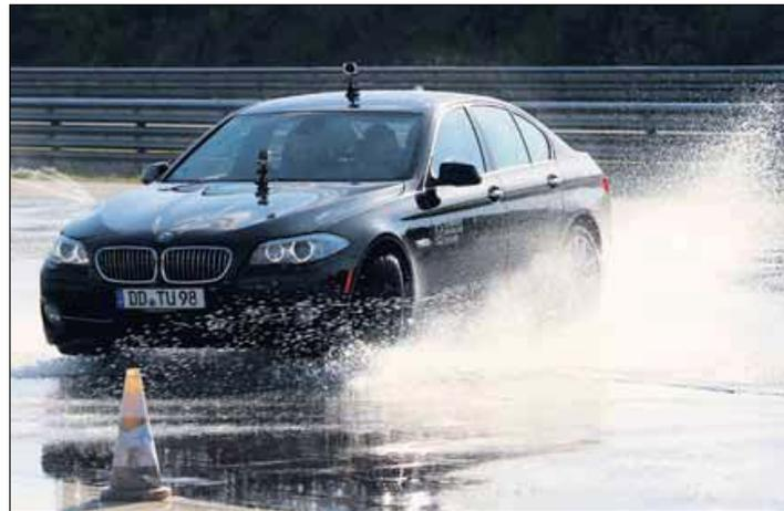
Im BMW 535i der Professur Kraftfahrzeugtechnik erfahren die Studenten die Reaktion eines Fahrzeuges während des Bremsens auf unterschiedlichem Reibbelag (m-split) und abgeschalteten Regelsystemen.
