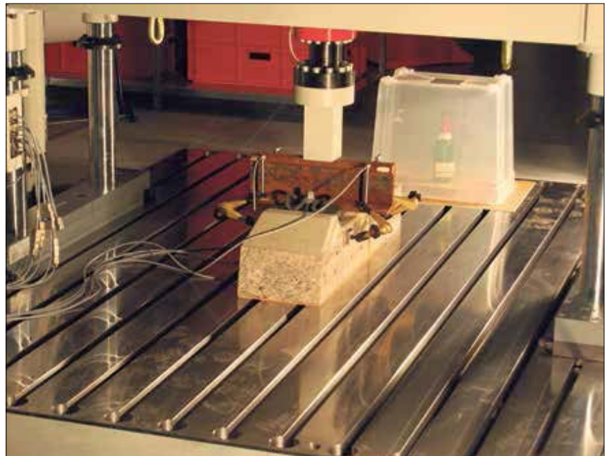
Mit der servohydraulischen Prüfmaschine können nicht nur ICE-Überfahrten mit 200 Kilometer pro Stunde getestet werden. Foto: Andrea Surma
