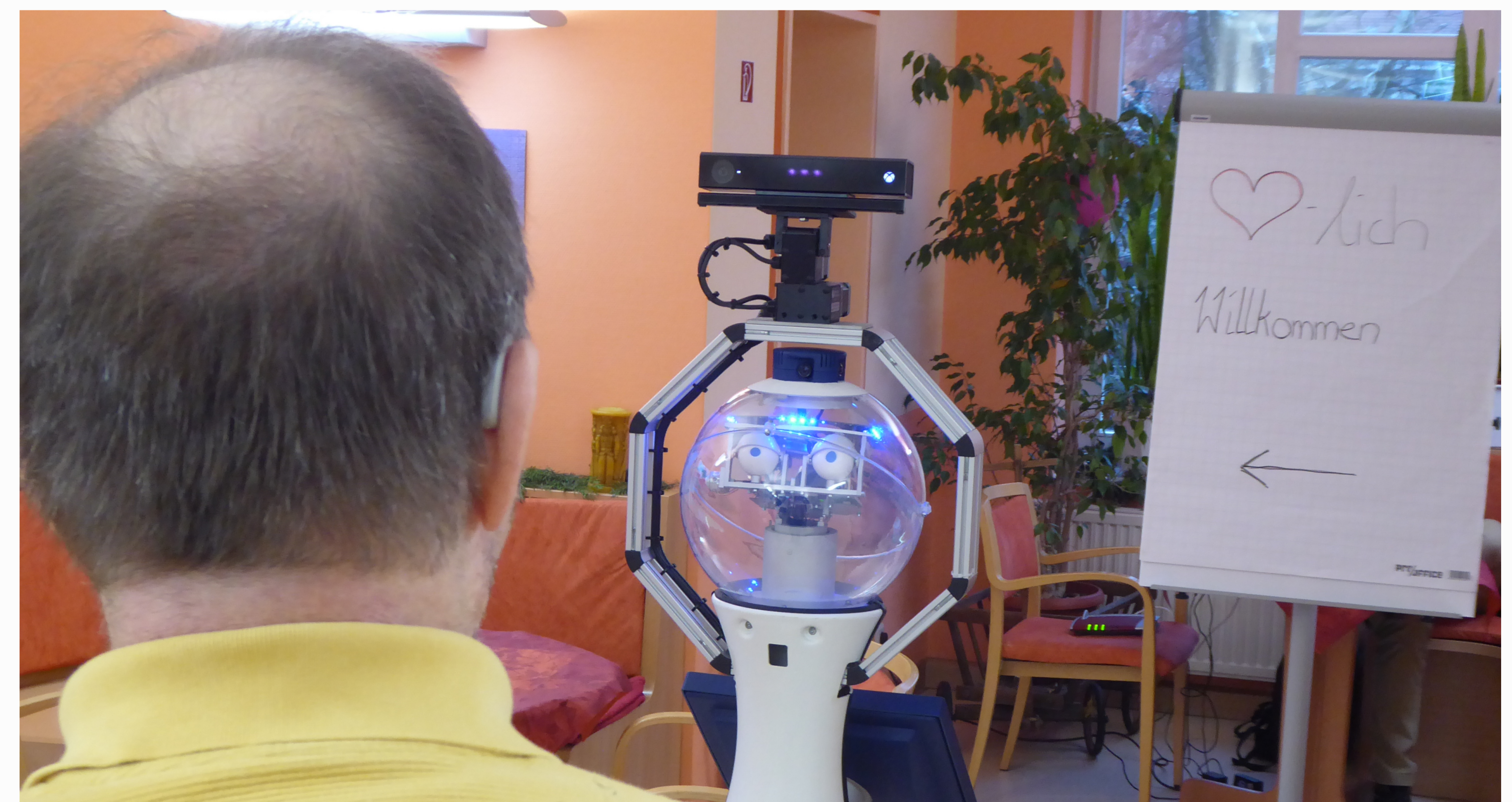
Roboter Anna Constantia begrüßt einen Patienten zur MAKS-Therapie. Der Roboter ist mit einem omnidirektionalen Laser Range Finder, Sonarsensoren und einer Kinect One RGB-D ausgestattet. Die Augen bzw. der Kopf des Roboters haben keinen sensorischen Einfluss.
