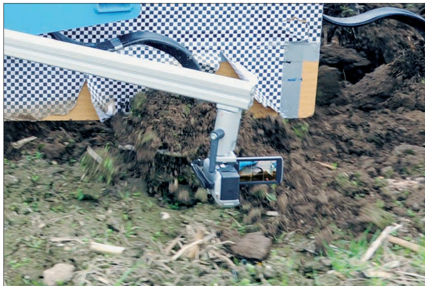
Film ab für den Star – ein Federzinken bei der Arbeit. Um die hochaufgelösten Filmaufnahmen besser auswerten zu können, haben die Wissenschaftler der TU Dresden als Hintergrund eine Platte mit Karomuster montiert.
