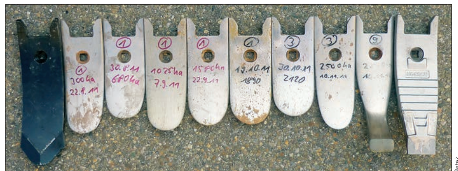
Schare unterliegen heute wegen der höheren Arbeitsgeschwindigkeit einem stärkeren Verschleiß. Hartmetallbestückung verlängert die Standzeit. Im Bild: Links ein normales Stahlschar und rechts ein Schar mit Hartmetallbeschichtung im unbenutzten Zustand. Das Hartmetallschar überstand an einem Grubber sieben Scharwechsel an den benachbarten Zinken.
