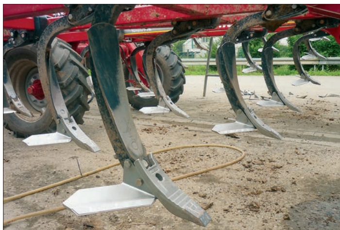
Mit Hartmetall beschichtete Flügelschare an einem Grubber mit starren Zinken der Firma Horsch.
