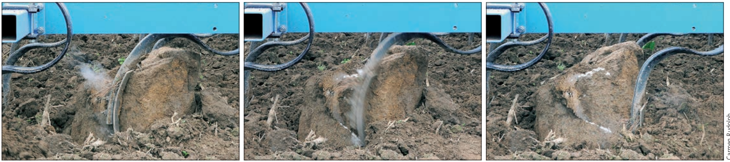
Szenen einer Begegnung: Federzinken trifft auf Feldstein. Beim Wegdrücken nach hinten und zur Seite sowie beim Vorschnellen muss der Zinken enorme Kräfte aufnehmen.
