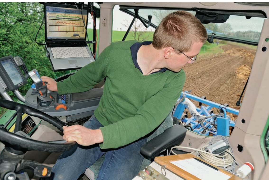
Bruno von der Planitz von der TU Dresden bei einer Messfahrt mit dem Grubber. Die Ergebnisse der Messfühler am Zinken und an der Dreipunktaufhängung werden im Laptop neben ihm aufgezeichnet.
