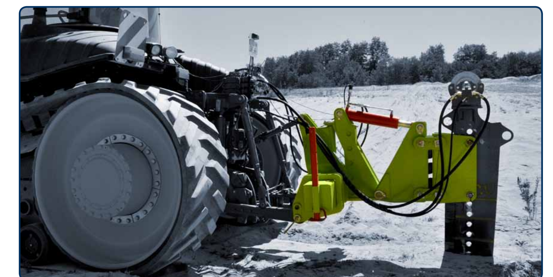
Funktionserprobung des Verlegesystems für die Agrarflächenkollektoren
