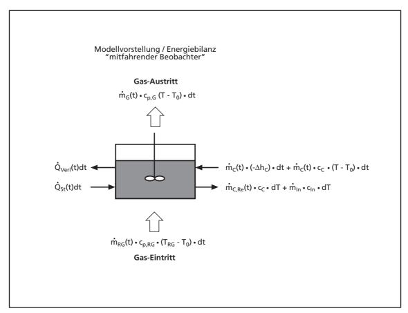
Bild 20: Energiebilanz an einem Rührkessel-Element
