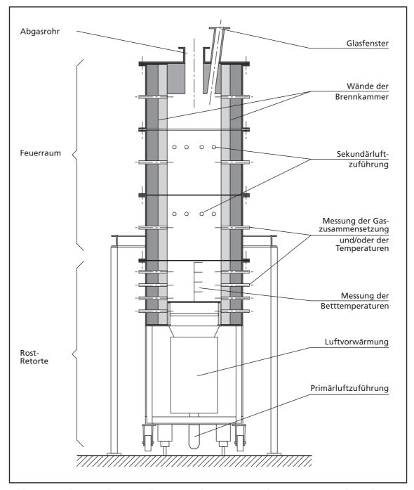
Bild 21: Schematische Darstellung eines Chargenrost-Reaktors zur Untersuchung des Feststoffumsatzes
