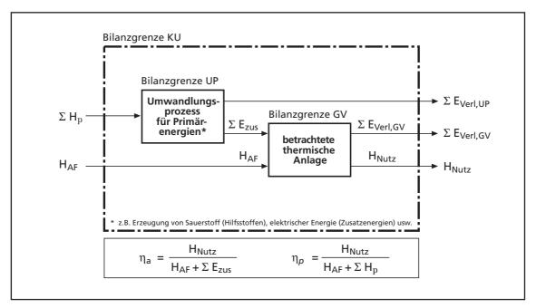
Bild 23: Vereinfachte Energiebilanz zur Bildung des Anlagenwirkungsgrades  $\eta_a$  und des Primärwirkungsgrades  $\eta_n$
