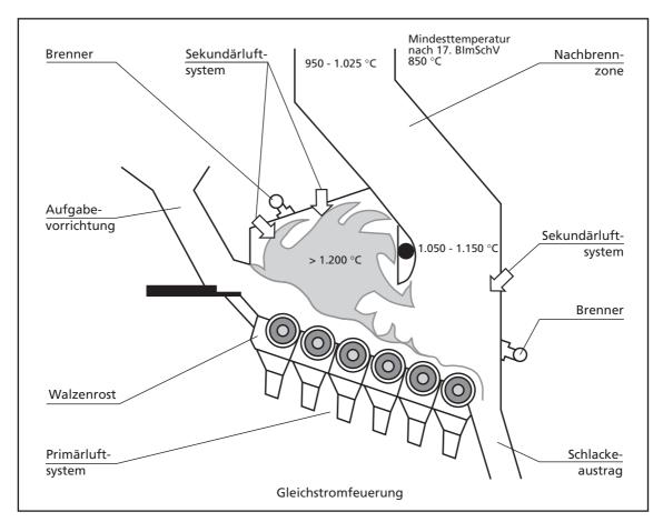
Bild 15: Trennung zwischen Rost- und Nachverbrennung durch Anordnung des Rührkesselelements für die Nachverbrennung über der ersten Hälfte des Walzenrosts
