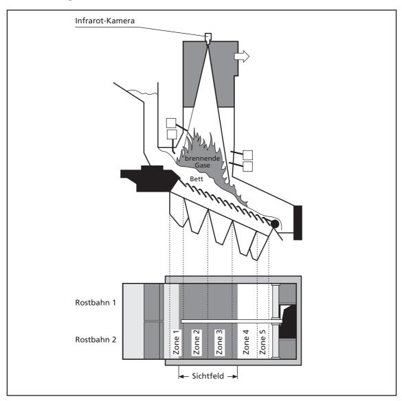
Bild 16: Regelung eines Rostes mit Infrarot-Kamera
