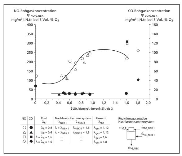
Bild 18: Gemessene NO- und CO-Rohgaskonzentration in Abhängigkeit von dem Stöchiometrieverhältnis bei über- und unterstöchiometrischer Betriebsweise der Rostanlage
