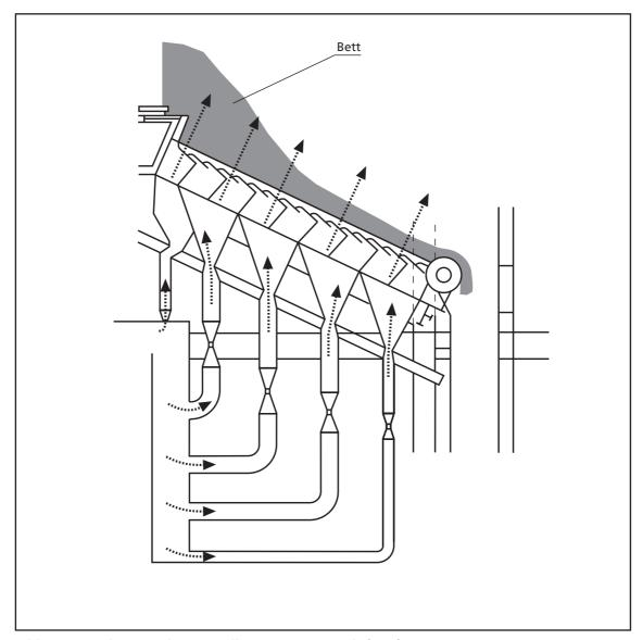
Bild 7: Schematische Darstellung einer Primärluftstufung
