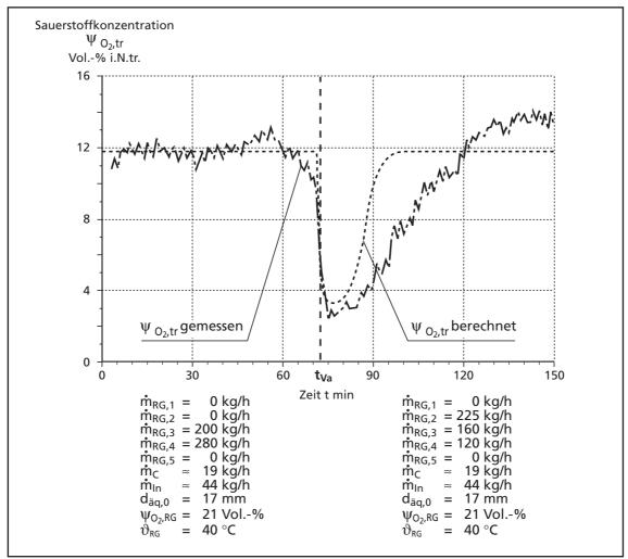
Bild 22: Feststoffumsatz auf dem Rost – gemessene und berechnete Sauerstoffkonzentration  $\psi_{0_{n},\,\mathrm{tr}}$  mit Umverteilung des Luftmassenstromes (Modellbrennstoff Braunkohle)
