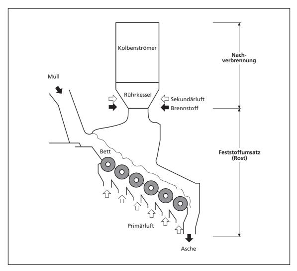
Bild 12: Schematische Darstellung der strömungstechnischen Trennung von Rost und Nachverbrennung
