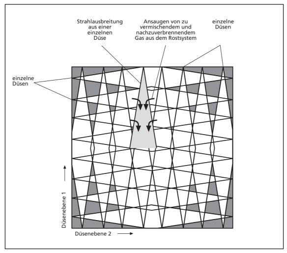
Bild 14: Möglichkeiten der Anordnung von Düsenfeldern in zwei Ebenen über einem Strömungsquerschnitt zur Herstellung eines *Rührkessel-*Elementes
