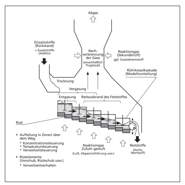
Bild 6: Prozessteilschritte beim Feststoffumsatz auf einem Rost – Modellvorstellung – Quelle: Beckmann, M.; Scholz, R.: Zum Feststoffumsatz bei Rückständen in Rostsystemen. In: Brennstoff-Wärme-Kraft (BWK) 46 (1994), Nr. 5
