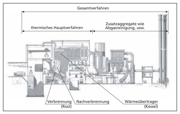
Bild 1: Schematische Darstellung eines klassischen Verfahrens zur thermischen Behandlung von Hausmüll (Verbrennungs-Nachverbrennungs-Verfahren)
