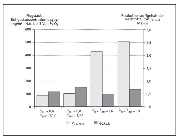
Bild 17: Staubkonzentrationen im Rohgas  $\kappa_{E,G,NBK}$  und Glühverlust der Reststoffe  $\xi_{C,Re,R}$  bei verschiedenen Stöchiometrieverhältnissen auf dem Rost
