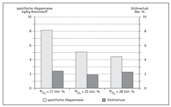
Bild 10: Spezifische Abgasmasse und Glühverlust der Asche bei unterschiedlichen Sauerstoffgehalten der Primärluft
