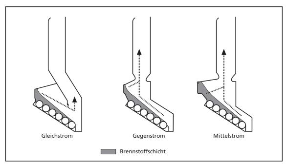
Bild 11: Schematische Darstellung verschiedener Möglichkeiten der Gasführung über dem Gutbett
