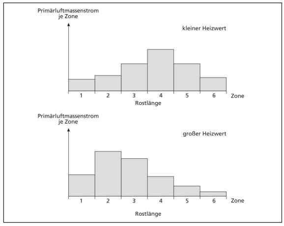
Bild 8: Verteilung des Primärluftmassenstromes über der Rostlänge bei Hausmüll mit unterschiedlichem Heizwert
