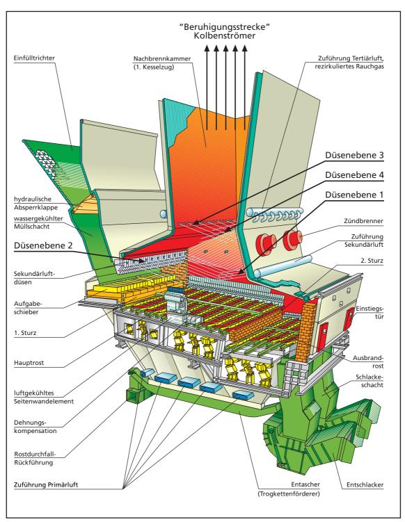
Bild 13: Schematische Darstellung eines Vorschubrostes mit anschließender Nachverbrennung
