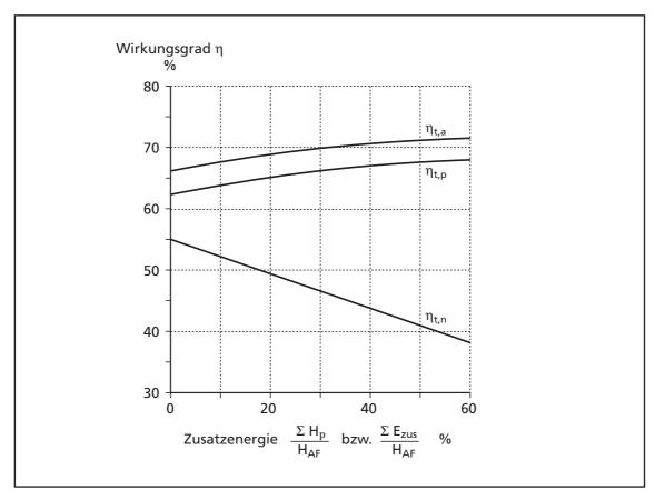
Bild 25: Beispiel für die Abhängigkeit des thermischen Anlagen-  $(\eta_{t,a})$ , Primär-  $(\eta_{t,p})$  und Nettoprimärwirkungsgrades  $(\eta_{t,n})$  von zusätzlich zur Abfallenergie  $H_{AF}$ erforderlichen Energien  $\Sigma$   $H_{D}$  bzw.  $\Sigma$   $E_{zus}$
