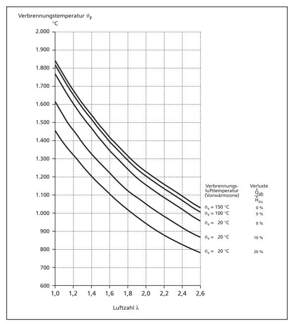
Bild 2: Verbrennungstemperatur  $\vartheta_F$  in Abhängigkeit von der Luftzahl  $\lambda$  für einen Hausmüll mit einem Heizwert  $h_u = 8,5$  MJ/kg bei Vorwärmung der Verbrennungsluft (Temperatur  $\vartheta_V$ ) und Wärmeverlusten ( $(\mathring{Q}_{ab}/\mathring{H}_{zu})$  als Parameter
