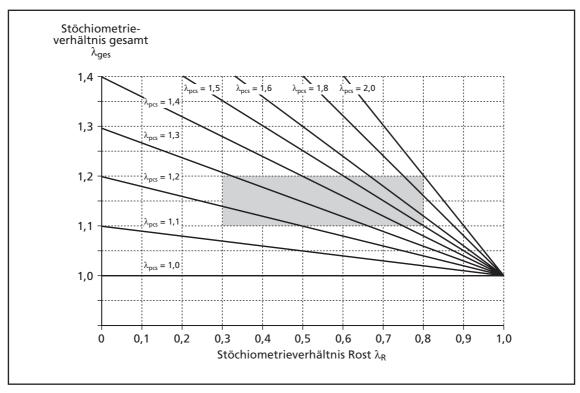
Bild 19: Abhängigkeit des Gesamtstöchiometrieverhältnisses im Rost- und im Nachbrennkammersystem
