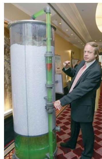
Dr. Lutz Haldenwang, der Verantwortliche für Biotechnologie bei der DAS, zeigt am Modell wie der Rieselstromreaktor arbeitet. Abb: DAS GmbH
