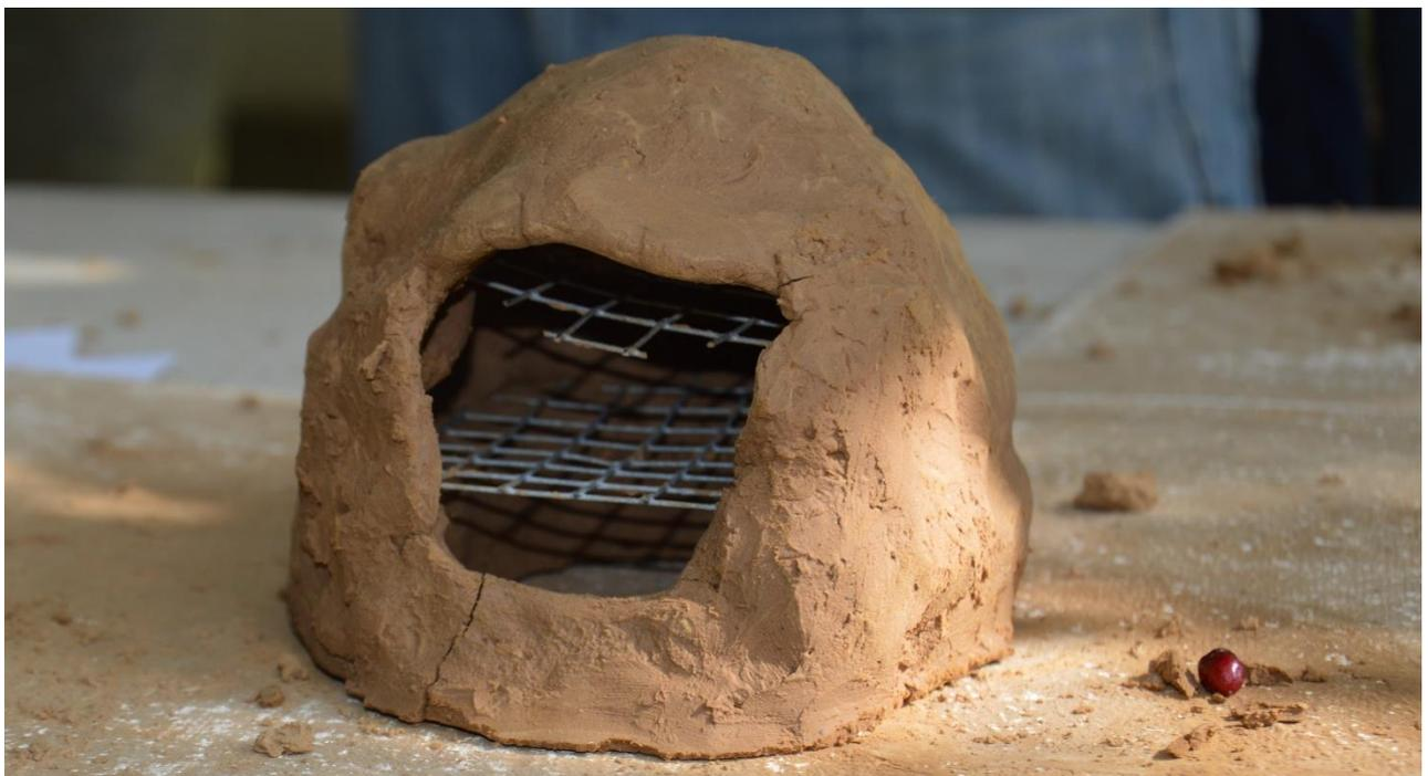
**Abb. 6:** Modellbau - Rissbildungen durch Schwinden des Lehms während der Trocknung
