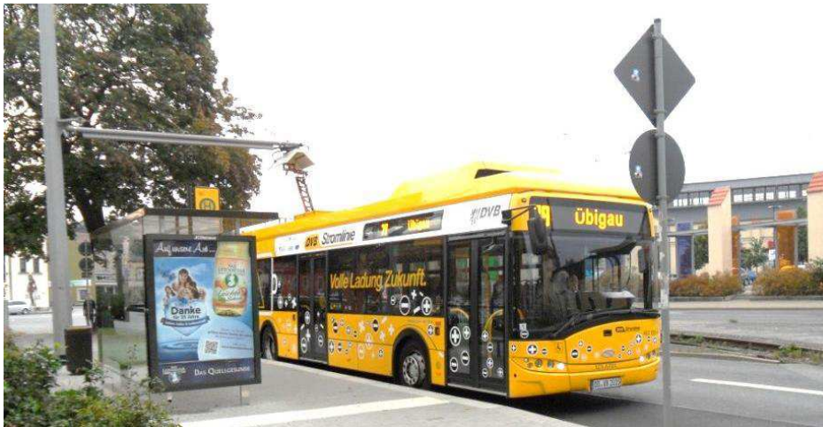
Abbildung 27: Der E-Bus am Wendepunkt mit einem Hochstrom-Ladegerät
