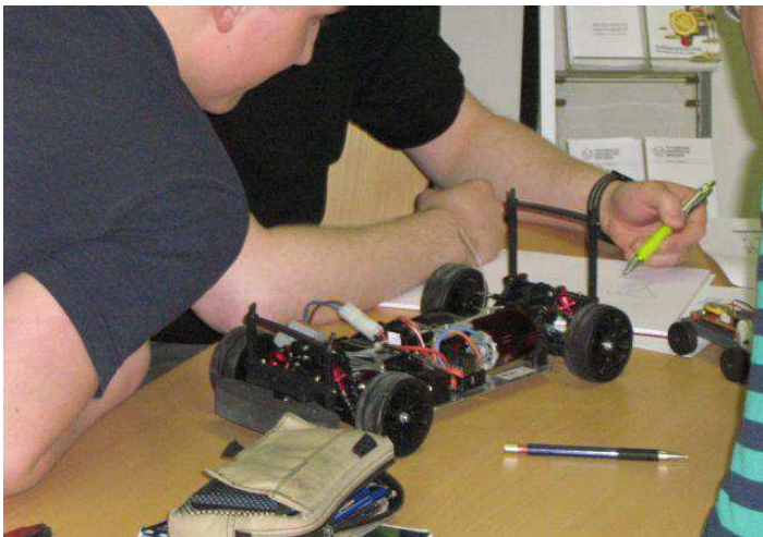
Abbildung 25: Demontage eines Modellautos mit Elektroantrieb
