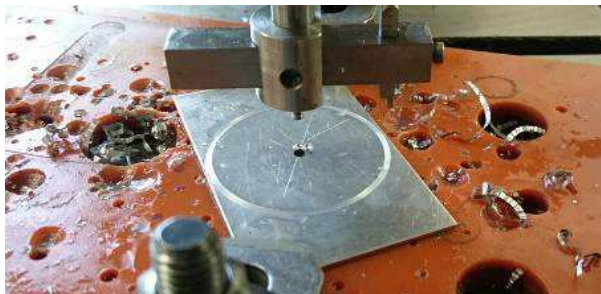
Abbildung 21: Ausschneiden eines Alu-Rades mit Kreisschneider auf der Bohrmaschine
