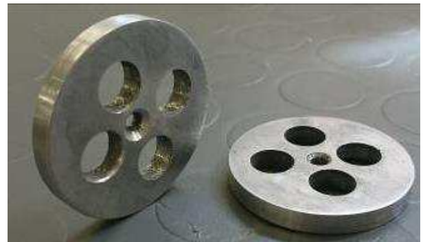
Abbildung 22: Ausgebohrte, gewichtsreduzierte Räder
