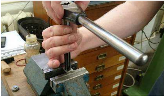
Abbildung 30: Reiben der Kugellagerpassung
