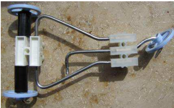
Abbildung 27: Chassis (Draht + Listerklemmen)
