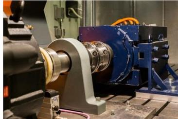
Prüfstand zum „Prüfstand Elektrische Maschinen und Antriebe (200 kW)“
