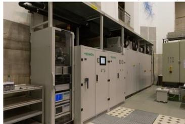
Schaltschrankbatterie zum „Prüfstand Elektrische Maschinen und Antriebe (200 kW)“
