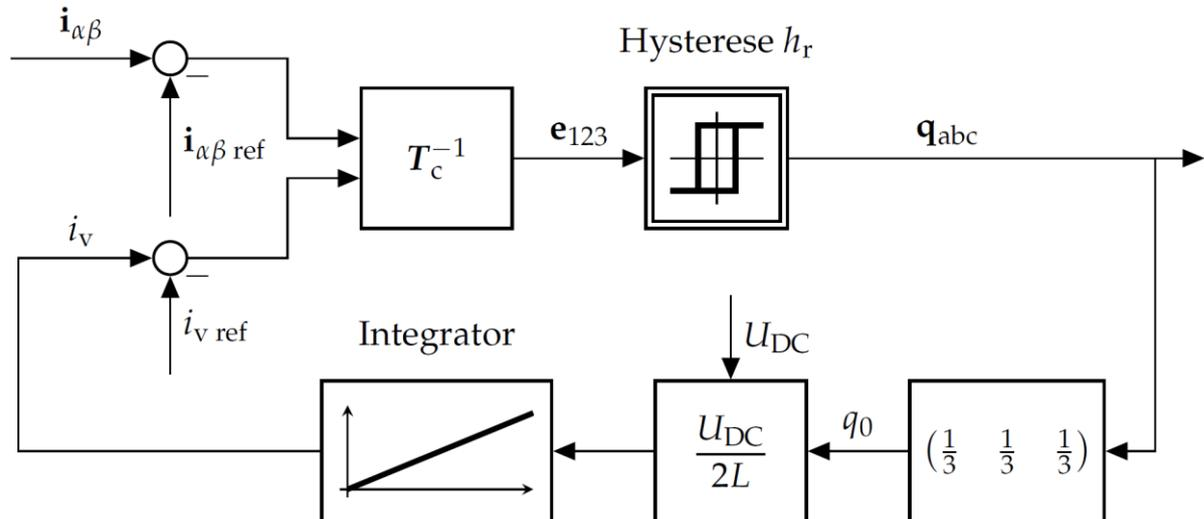
Vor einigen Jahren wurde an der Professur ein Gleitregimeregler (Sliding Mode Control) entwickelt.
