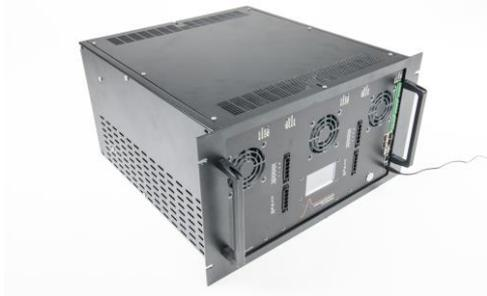
Für die Inbetriebnahme moderner Netzstromrichter ist eine geeignete Testumgebung erforderlich. Dabei muss das Verhalten des Versorgungsnetzes realistisch nachgebildet werden. Hierfür können sogenannte Netzemulationen eingesetzt werden, die in der Lage sind, eine definierte dreiphasige Netzspannung auszugeben.
