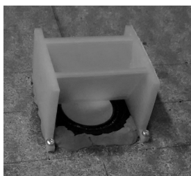
Abbildung 5: Bild des Reflektors im eingebauten Zustand, direkt vor dem Lautsprecher.
