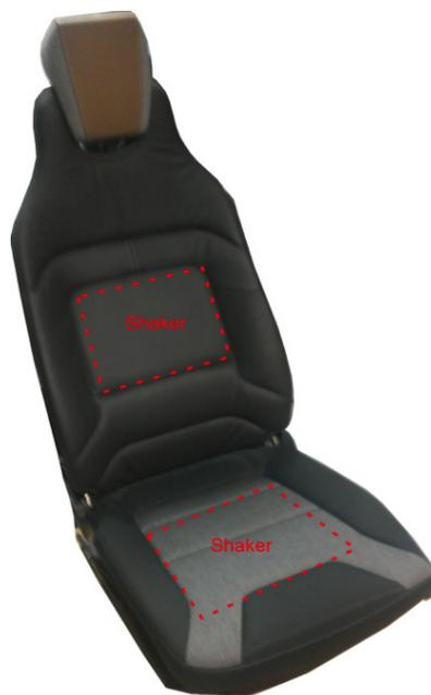
Abbildung 1: Fahrzeugsitz mit elektro-dynamischen Shakern.
