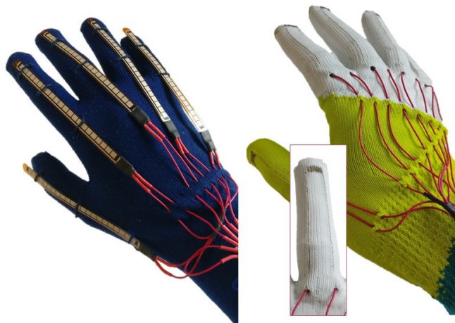
Abbildung 1: Beide getesteten Handschuhe im Vergleich. Links Handschuh 1 mit handelsüblichen Flexsensoren, rechts Handschuh 2 mit direkt eingestrickten Sensorgarnen.
