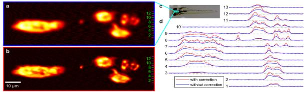
Fluoreszenzaufnahmen der Schilddrüse von transgenen Zebrabärblingsembryonen ohne (a) und mit (b) Korrektur sphärischer Aberrationen. Aufnahme des gesamten Embryos, Dimensionen sind ca (1.5x5) mm2 (c). Intensitätsprofile entlang spezifischer Zeilen (d). Die Aufnahmen erfolgten 110 Stunden nach der Befruchtung.
