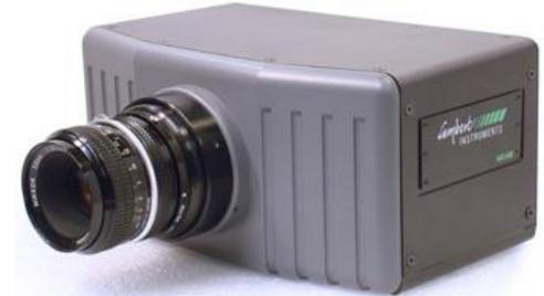
Bildverstärker mit Hochgeschwindigkeitskamera
