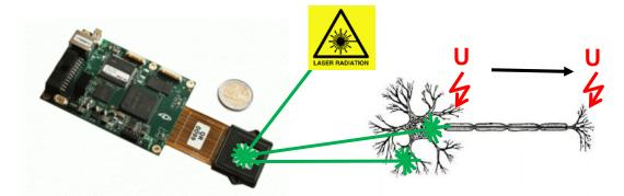
Schema der Optogenetik: Licht von einer Lichtquelle (Laser) wird räumlich verteilt auf lichtempfindliche Zellkulturen gelenkt, welche daraufhin elektrische Signale generieren, die detektiert werden können. Nutzt man einen örtlichen Lichtmodulator, so können mehrere Zellen gleichzeitig oder einzelne Zellen an mehreren beliebigen Stellen aktiviert werden.
