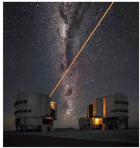
Laserleitstern beim VLT Teleskop
