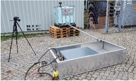
Aufbau zur Untersuchung des Kurzschlussverhaltens von Lilon-Batterien
